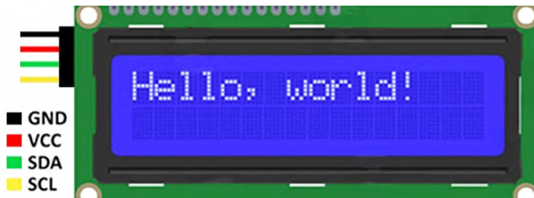
Рис. 1. Подключение модуля ЖКИ к Ардуино
