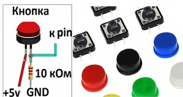
Рис. 1. Схема подключения тактовой кнопки к микроконтроллерной плате
