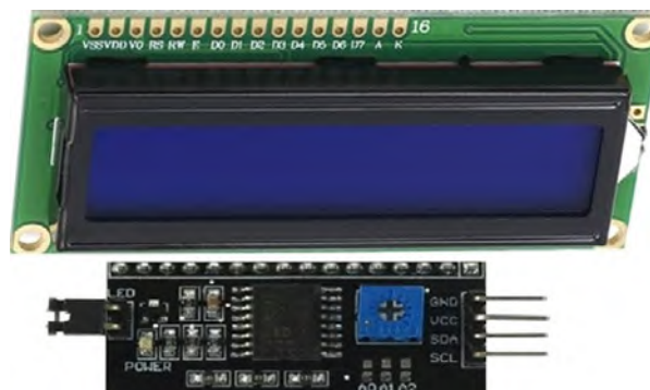
Рис. 17. Дисплей (жидкокристаллический индикатор — ЖКИ 16×2)
