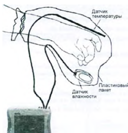
Рис. 17. Схема экспериментальной установки терморегуляции кожи
